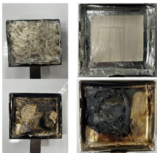
Рисунок 7 - Образцы ковра и линолеума ПВХ до и после токсикологических испытаний.
