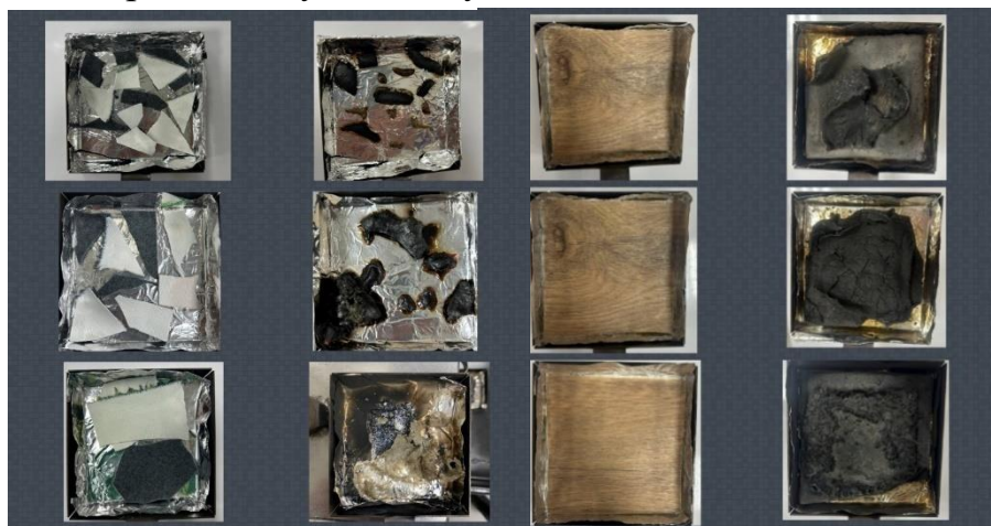
Рисунок 6 - Образцы пожарной нагрузки «Шерсть+нейлон» и «Линолеум» до (слева) и после (справа) испытаний.
