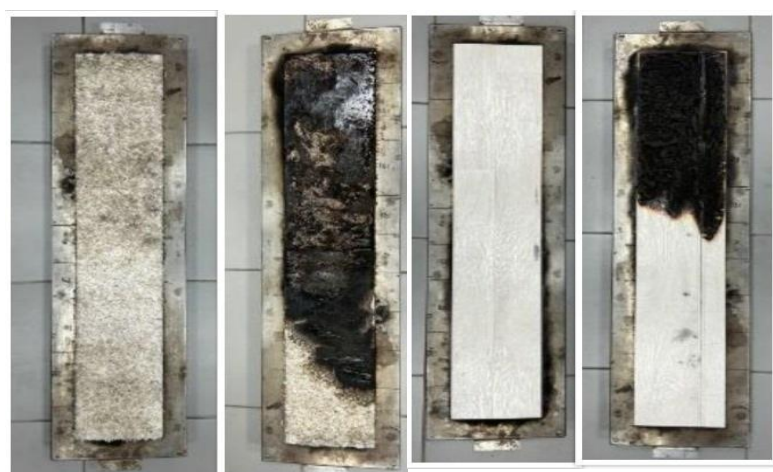
Рисунок 8 - Ковер и линолеум ПВХ до/после испытаний на линейную скорость распространения пламени.
